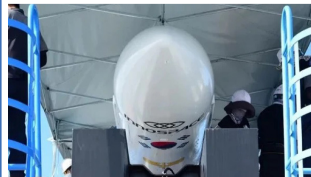
O HANBIT-TLV é um lançador de satélites que mede 16,5 metros e pesa 8,4 toneladas. (Divulgação / Innospace)
